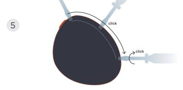
Schieben Sie den Schraubendreher vorsichtig an der Kante des Activ5 entlang, sodass die Spitze innerhalb der Öffnung bleibt, bis Sie zu der Stelle gelangen, die in der Abbildung angezeigt ist. Halten Sie dann an und drehen Sie vorsichtig, bis Sie ein KLICKEN hören. Der Deckel ist nun geöffnet und Sie können ihn vorsichtig anheben.
